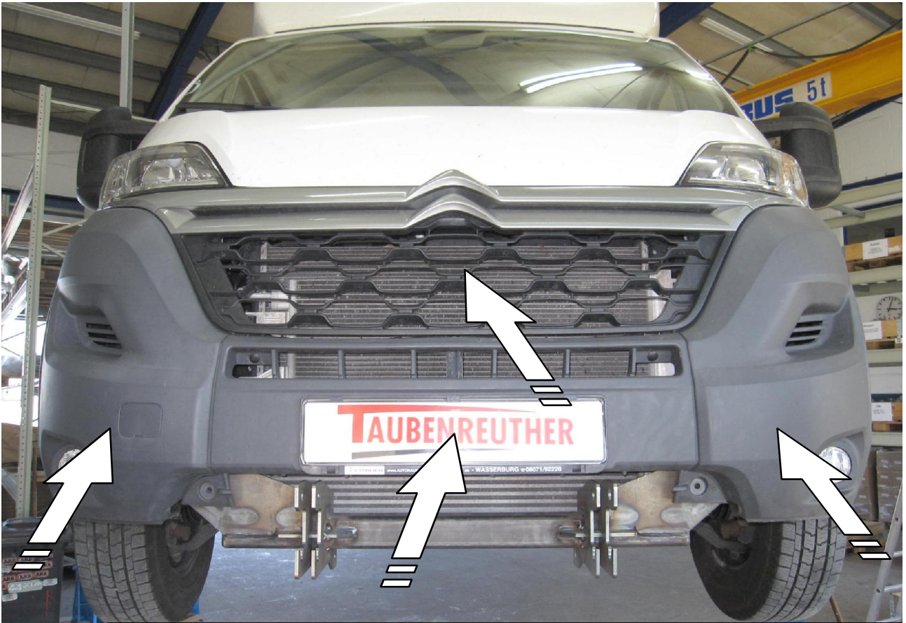
15 Stoßfänger und Scheinwerfer wieder montieren! Mount the bumper and the lights again!
